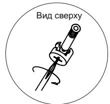
**Схема соединения болта 2 с эксцентриком**
