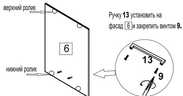
**Внимание:** Засверловка в фасаде под ролики универсальная, под разные типы роликов для раздвижных дверей. Установленные ролики **11** необходимо зафиксировать на фасаде **6** закрепив шурупом **10**.
