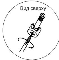
**Схема соединения болта с эксцентриком**
