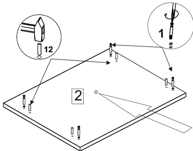
Если готовое изделие будет устанавливаться между шкафами и необходимо закрепить, то нужно досверлить наметку под отверстие сверлом  $d=5\text{мм}$ . Фиксирование произвести стяжкой межкорпусной **2**. Если данная функция не требуется, то отверстие закрыть заглушкой **14**.
